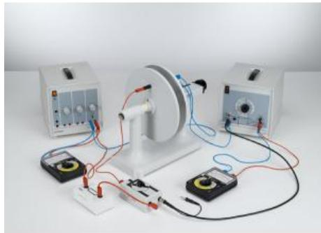
L'expérience P3.1.7.3 consiste à mesurer avec précision la capacité C d'un condensateur à plaques en fonction de la distance d entre les plaques.
