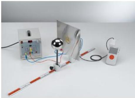
L'expérience P3.1.7.6 consiste à déterminer le potentiel du champ électrique sur la surface d'une plaque conductrice qui se trouve à une distance  $r$  à une sphère chargée.
