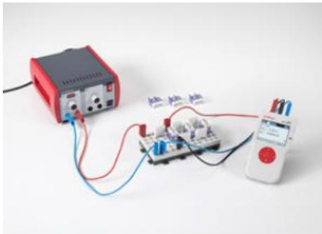
L'expérience P3.2.3.1 consiste à vérifier si les lois de Kirchhoff sont valables dans des circuits électriques avec des résistances branchées en parallèle et en série.
