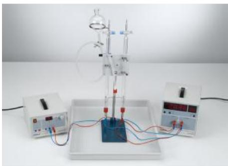
Dans l'expérience P3.2.5.1, on produit une certaine quantité d'hydrogène à l'aide d'un appareil d'électrolyse selon Hofmann, afin de déterminer la constante de Faraday.
