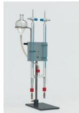
Voltamètre d'Hofmann, pour l'électrolyse de l'eau.
