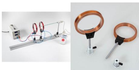
Dans l'expérience P3.3.4.3, on étudie l'homogénéité d'un champ magnétique dans une paire de bobines de Helmholtz.
