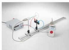
Dans l'expérience P3.3.4.1, on mesure le champ magnétique d'un conducteur droit et long pour différentes intensités I du courant, en fonction de la distance r au conducteur.
