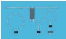
Pour mesurer l'induction magnétique sur des conducteurs rectilignes et annulaires parcourus par un courant (loi de Biot et Savart).
