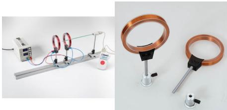
Dans l'expérience P3.3.4.6, on étudie l'homogénéité d'un champ magnétique dans une paire de bobines de Helmholtz.
