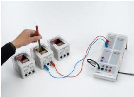
L'expérience P3.4.1.1 consiste à produire un saut de tension en plaçant manuellement un barreau magnétique dans une bobine sans fer, ou en le retirant de la bobine.
