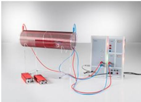
**P3.4.3.2 Mesure de la force électromotrice induite dans une boucle conductrice**
