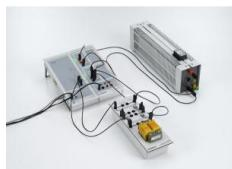
L'expérience P3.4.5.3 consiste à représenter la tension primaire et la tension secondaire de même que le courant primaire et le courant secondaire d'un transformateur en charge.
