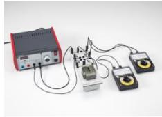
L'objet de l'expérience P3.4.5.1 est de mesurer la conversion de la tension d'un transformateur à vide et la conversion du courant d'un transformateur en court-circuit.
