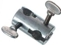
Pour assembler des tiges et des tubes.
