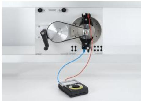
Les deux types de génératrices sont montés avec un aimant permanent dans l'expérience P3.5.2.1.
