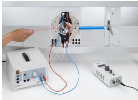
L'expérience P3.5.3.3 consiste à étudier un moteur dit universel, où les champs du stator et du rotor sont excités électriquement.
