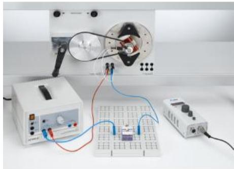
L'expérience P3.5.3.4 consiste à synchroniser manuellement le rotor bobiné du moteur synchrone à courant alternatif avec la fréquence de la tension appliquée, afin qu'il fonctionne de manière autonome par la suite.
