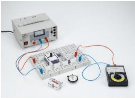
Dans l'expérience P3.6.1.3 un gros condensateur avec une longue constante de temps est chargé et déchargé lentement.
