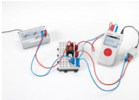
Dans l'expérience P3.6.2.4, on applique une tension alternative d'amplitude  $U_0$  et de fréquence  $f$  à une bobine. La tension  $U_L(t)$  et le courant  $I_L(t)$  sont représentés sur Mobile-CASSY 2.
