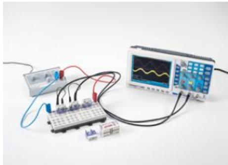
Dans l'expérience P3.6.3.1, on combine une capacité C avec une résistance R, dans l'expérience P3.6.3.2, on combine une inductance L avec une résistance R.
