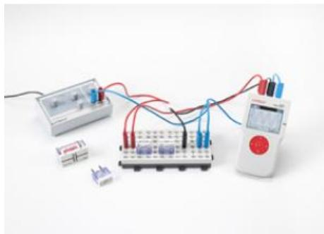
Dans l'expérience P3.6.3.4, on combine une capacité C avec une résistance R, dans l'expérience P3.6.3.5, on combine une inductance L avec une résistance R.
