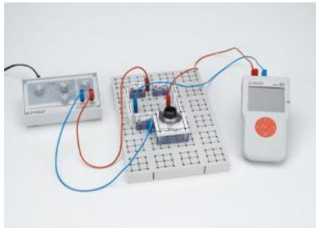
Dans l'expérience P3.6.4.2, on étudie le principe dun pont de Wien pour la mesure dune résistance capacitive Z1.
