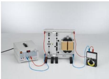
L'expérience P3.7.1.1 consiste à étudier les oscillations électromagnétiques libres. L'atténuation est si faible que plusieurs périodes d'oscillations peuvent être suivies, et leur durée peut se mesurer. On observe les écarts entre période d'oscillation mesurée et période d'oscillation calculée à partir de la formule de Thomson
