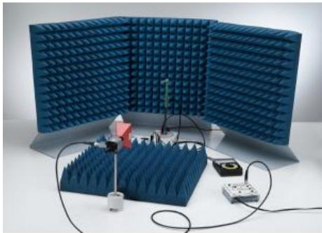
Dans l'expérience P3.7.6.2, on transforme une antenne dipolaire en une antenne Yagi à l'aide de éléments passifs afin d'améliorer la propriété de directivité du montage.
