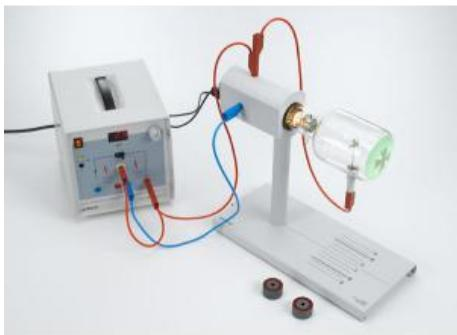
L'expérience P3.8.3.1 consiste à mettre en évidence la propagation rectiligne des électrons dans un espace sans champ.
