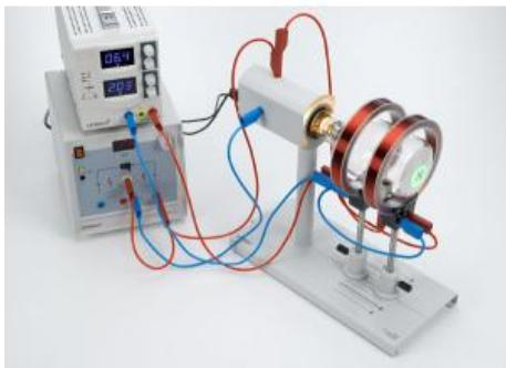
L'expérience P3.8.3.2 consiste à utiliser un électroaimant pour produire un champ magnétique axial. La croix de Malte se tourne et diminue en fonction du courant de la bobine.
