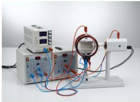
Dans l'expérience P3.8.5.2, on monte un filtre de vitesses (filtre de Wien) avec un champ électrique et un champ magnétique croisés, ce qui permet entre autres de déterminer la charge spécifique des électrons de manière plus précise.
