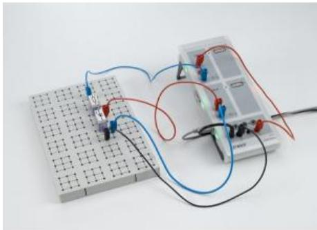
Dans l'expérience P4.1.3.4, on mesure puis on trace avec CASSY la caractéristique d'une diode au silicium et d'une diode au germanium.
