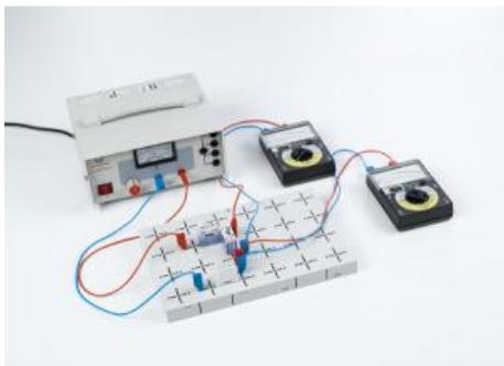
Le but de l'expérience P4.1.4.3 est de réaliser un circuit pour vérifier la polarité de la tension avec une diode électroluminescente verte et une diode électroluminescente rouge.
