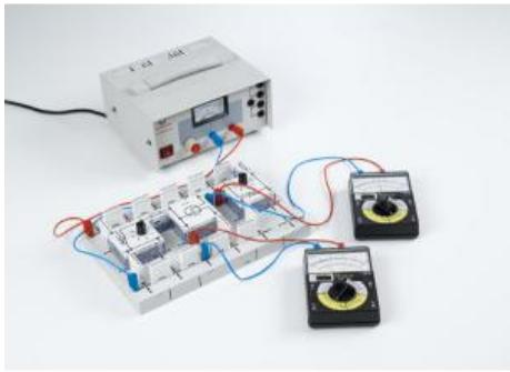
Au cours de l'expérience P4.1.5.3, on mesure puis on trace la caractéristique d'un transistor à effet de champ, c.-à-d. le courant de drain ID en fonction de la tension UDS entre drain et source pour une tension de grille UG constante.
