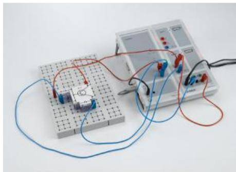
Dans l'expérience P4.1.5.4, on étudie les propriétés d'un transistor npn à l'appui de ses caractéristiques.
