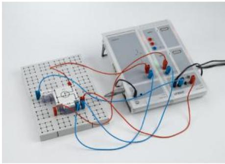
Au cours de l'expérience P4.1.5.5, on mesure puis on trace la caractéristique dun transistor à effet de champ, c.à-d. le courant de drain ID en fonction de la tension UDS entre drain et source pour une tension de grille UG constante.
