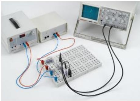
Un phototransistor monté comme une photodiode et dont la base n'est pas connectée fait l'objet de l'expérience P4.1.7.1.
