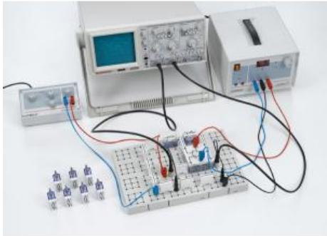
Dans les expériences P4.2.2.2 et P4.2.2.3, l'amplificateur opérationnel est relié à l'entrée inverseuse, ou non inverseuse, par une résistance R2.
