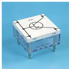
Étages préliminaires et interrupteurs pour faibles signaux.
