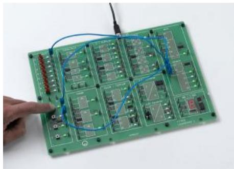
Dans l'expérience P4.5.2.3, on démontre la dérivation avec un multiplexeur de plusieurs entrées sur une sortie ainsi que la répartition avec un démultiplexeur des signaux d'une ligne d'entrée sur plusieurs lignes de sortie.
