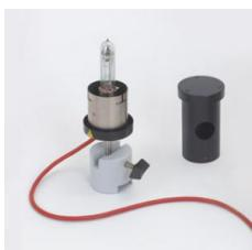
Pour la fixation et le branchement des lampes spectrales (451011 -111) à la bobine de self universelle ( 45130 ).
