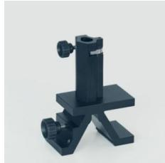
Cavalier pour banc d'optique à profil normalisé.
