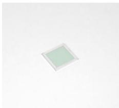
Filtre à bande étroite d'une longueur d'onde de 546 nm.
