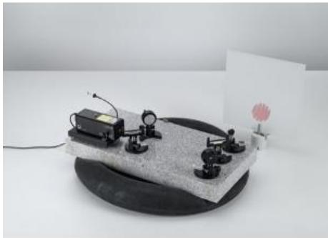
Dans l'expérience P5.3.5.1, on monte l'interféromètre de Mach-Zehnder sur une plaque de base pour optique laser insensible aux secousses.
