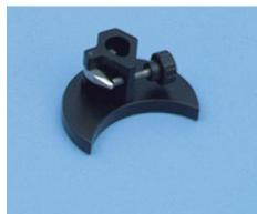
Sert de support pour les composants optiques sur la plaque de base pour optique laser ( 473 40 ).
