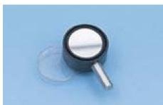
Inclinaison du miroir réglable verticalement et horizontalement par deux vis moletées.
