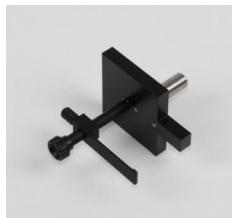
Pour la fixation quasiment sans vibration ou la mise en place des petits objets à holographier.
