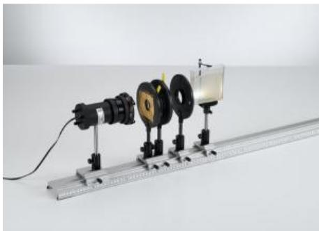
Dans l'expérience P5.4.1.3, on met en évidence le fait que la lumière non polarisée devient polarisée par diffusion dans une émulsion, par exemple du lait dilué, et que de la lumière polarisée n'est pas diffusée uniformément dans toutes les directions.
