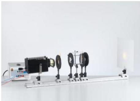
Dans l'expérience P5.4.3.3, on monte un polarimètre à pénombre à partir d'éléments discrets: un polariseur et un analyseur entre lesquels on place la substance optiquement active.
