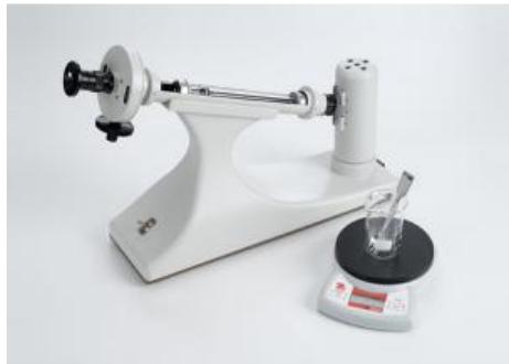
Dans l'expérience P5.4.3.4, il sagit de mesurer des concentrations de sucre à laide dun polarimètre de type commercial et de les comparer avec les valeurs mesurées lors des expériences.
