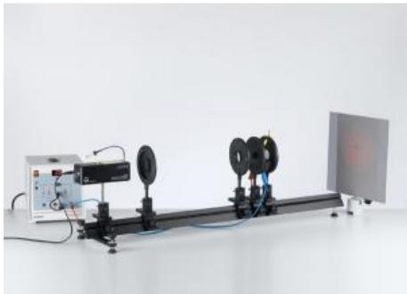
Dans l'expérience P5.4.5.1, on démontre leffet Pockels sur un cristal de niobate de lithium placé dans le trajet conoscopique dun faisceau lumineux.
