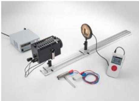
Dans l'expérience P5.5.1.1, on mesure le clairement énergétique à laide de la pile thermoélectrique de Moll et le clairement lumineux avec le capteur de lumière.
