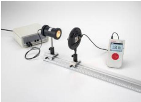
Dans l'expérience P5.5.1.2, on met en évidence le fait que l'éclairement lumineux dépend du carré de la distance séparant une source lumineuse ponctuelle et la surface éclairée.
