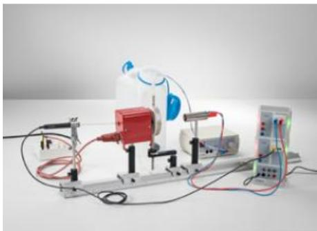
Dans les expériences P5.5.2.1 et P5.5.2.2, on se sert comme corps noir d'un four muni d'un cylindre en laiton bruni. On chauffe ce cylindre dans le four à la température désirée pouvant varier de 300 à 750 K.
