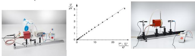
Dans les expériences P5.5.2.1 et P5.5.2.2, on se sert comme corps noir d'un four muni d'un cylindre en laiton bruni. On chauffe ce cylindre dans le four à la température désirée pouvant varier de 300 à 750 K.
