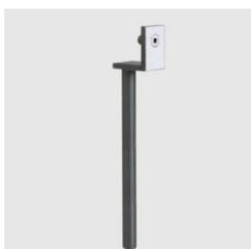
Pour positionner une fibre en verre ou en plastique sur le banc d'optique.
