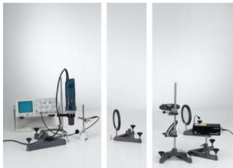
Dès que le miroir tournant tourne à une fréquence élevée, on observe un déplacement de l'image sur la réglette graduée : pendant le temps
